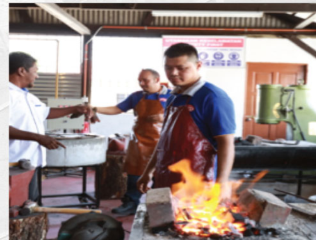
Kerja - kerja pemanasan besi sebelum dibentukkan
